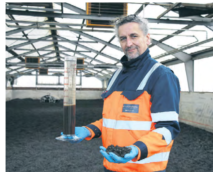
Ein deutlicher Unterschied. Links hält Abwassermeister Martin Morzik das Glas mit dem flüssigen Schlamm nach der ersten Entwässerung in der Presse, rechts das Granulat nach der solaren Klärschlamm-trocknung.
